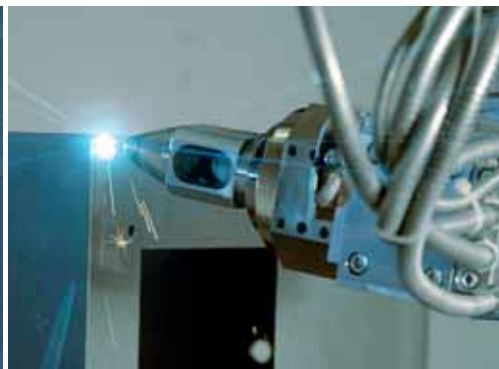
Vollautomatische 24h-Produktion mit Laserschweißanlagen und Schweißrobotern
