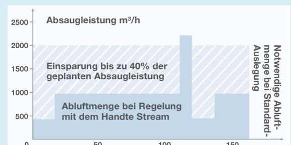
Einsparung von Luftleistung am Beispiel Bearbeitungszyklus einer Werkzeugmaschine
