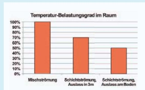
Vergleich Mischlüftung zu Schichtlüftung mit Luftauslaß in 3 m und am Boden
