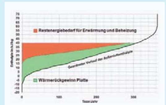
Energieeinsparung eines Plattenwärmetauschers von bis zu 60% p.a.
