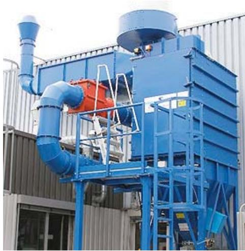
Handte Trockenfilter MF-Ultra Ex-Ausführung
