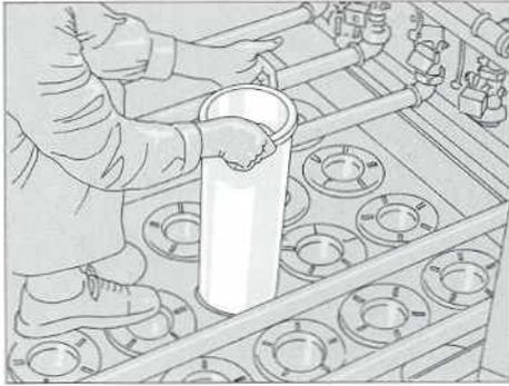
Filterschlauch in den Schlauchboden einführen und in die Filterkammer absenken.
