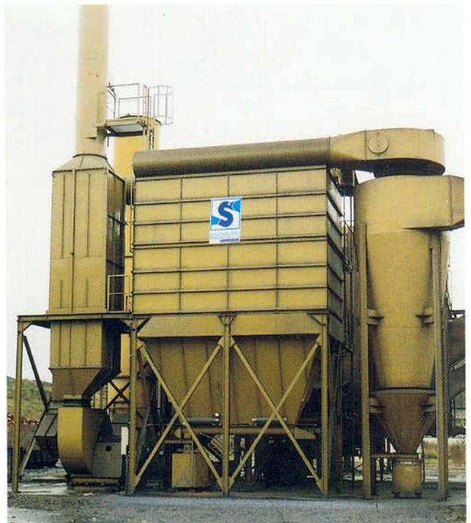
Absauganlage für Magnesiumschmelzofen. Absaugmenge 42.500 Bm<sup>3</sup>/h.
